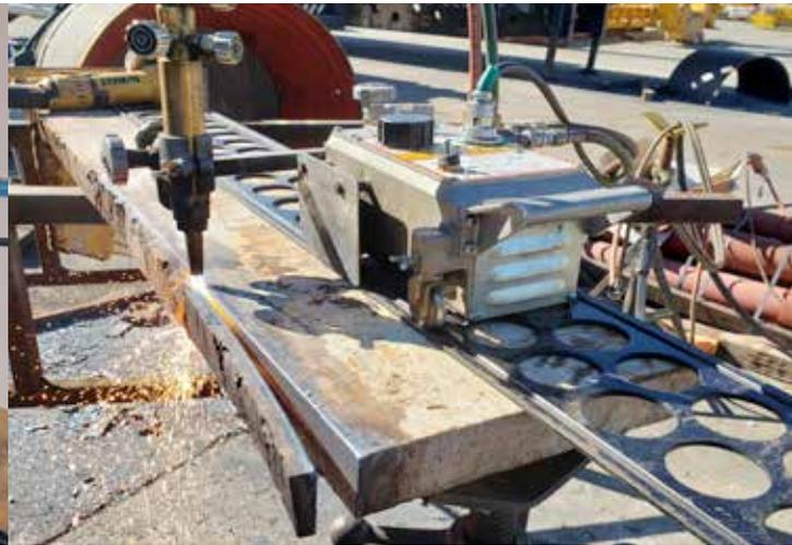
La IK-12 Beetle est une machine de coupe chalumeau abordable et portable. Elle est connue à travers le monde comme étant l'une des meilleures machines de coupe portables de l'industrie.
