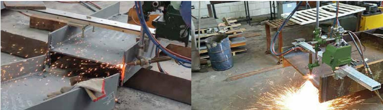
La Mini-Mantis II est une machine semi-automatique conçue pour la coupe rapide et précise de l'âme et de la bride de la poutre en H. La construction de qualité de KOIKE vous offre une machine de coupe au gaz économique, efficace et compact pour l'acier de poutre en H.
