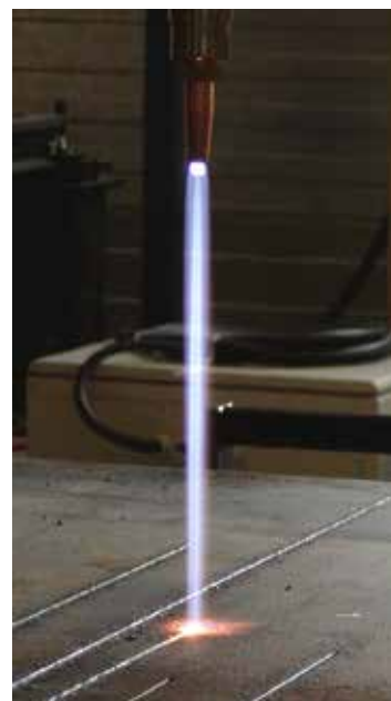
Fort débit d'oxygène de coupe provenant d'une buse divergente : Photo prise en interne chez KOIKE test de performance. Pointe de buse à 275 mm au-dessus de la plaque, buse 106-D7#0.
