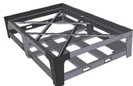
Starr verschweißter Schneidetischrahmen
