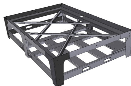
Cadre de la table de découpe rigoureusement soudé
