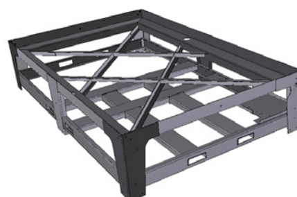
Telaio del banco da taglio rigidamente
