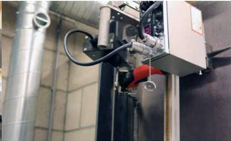
La série IK-72W est utilisée pour le soudage droit en position horizontale et verticale à l'aide de rails 1D et pour le soudage plan courbe et tordu à l'aide de rails 2 D et 3D. En utilisant le même système de rails que la machine de découpe IK-72T, la découpe et le soudage peuvent être effectués avec le système IK-72 dans un emballage pratique et léger.
