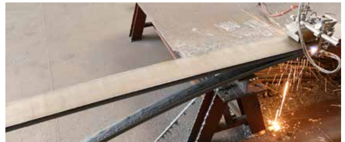
S-100 Set cannello con opzione barra scorrevole lunga e rullo guida.
