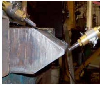
S-200 Set cannello con opzione barra scorrevole lunga.
