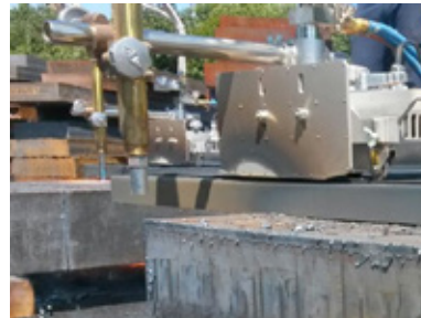
EPOCH Brennersatz mit Führungsschiene für hohe Beanspruchung
