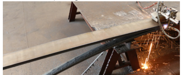
S-100 Brennersatz mit langer Gleitschiene und optionaler Führungsrolle
