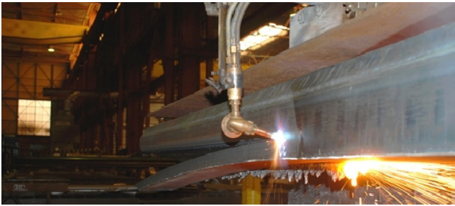
S-100 toortsset met verlenging en laskantvoorbereiding
