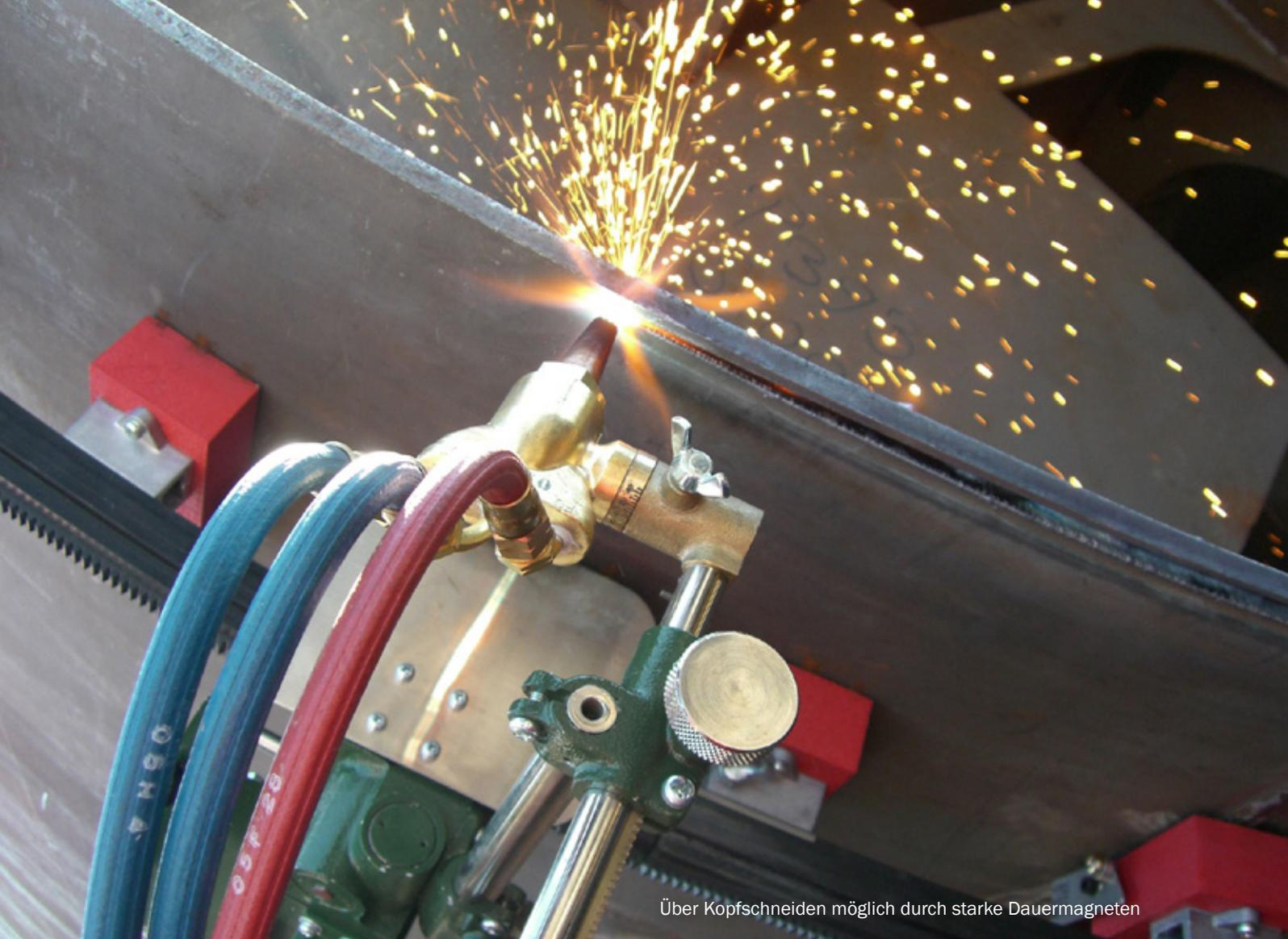
Über Kopfschneiden möglich durch starke Dauermagneten
