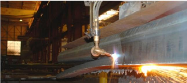
S-100 mit langer Gleitschiene und Winkeldüsenhalter
