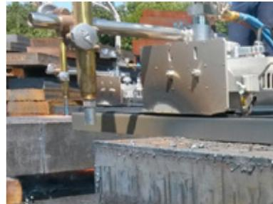
EPOCH Brennersatz mit Führungsschiene für hohe Beanspruchung
