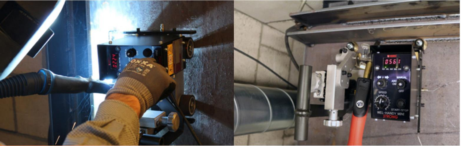
Der WEL-HANDY MINI STRONG ist ein Schweißfahrzeug mit kompaktem Design, der konzipiert wurde, um horizontales, vertikales und Überkopf-Schweißen durchzuführen. Der 35 kg starke Magnet in Verbindung mit 16 kg Zugkraft sorgt für eine zuverlässige Leistung für qualitativ hochwertige Schweißarbeiten. Die Maschine kann am Griff, der mit einem magnetischen Lösemechanismus ausgestattet ist, einfach abgehoben und getragen werden.
