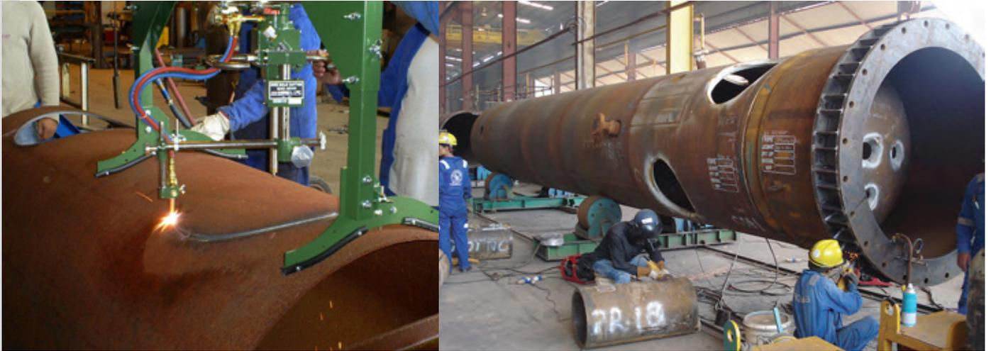
Die KHC-600D eignet sich ideal für das präzise Ausschneiden von Löchern für T-Rohrverbindungen, einschließlich Löcher für alle möglichen seitlichen Rohranschlüsse in einem Verrohrungssystem, Hochdruckgefäßen und Wärmetauschern. Entwickelt mit KOIKE Advanced Technology, ist die KHC-600D kompakt, von geringem Gewicht und einfach in der Bedienung. Zusätzlich zum Schneiden von Löchern mit oder ohne Fase auf flachen Platten, kann die Maschine Behälter von innen oder von außen schneiden.
