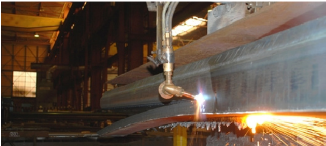
S-100 toortsset met verlenging en laskantvoorbereiding
