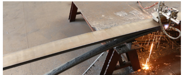
S-100 toortsset met geleider optie en laskantvoorbereiding
